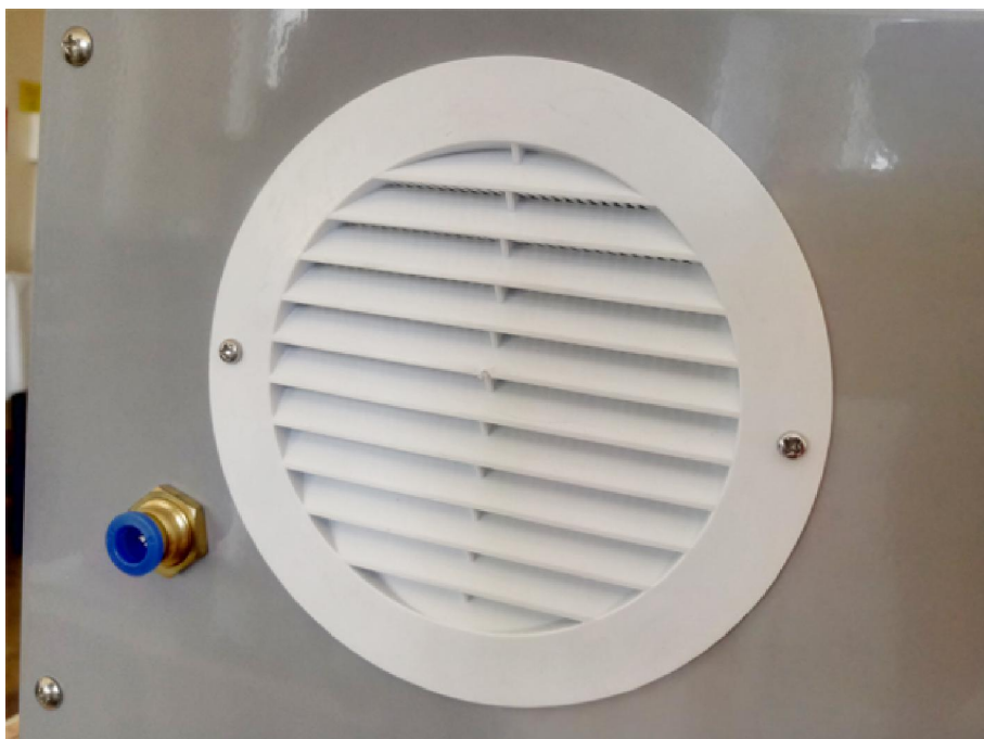
Вентиляция и штуцер
